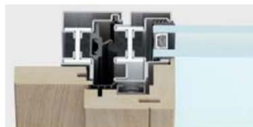
nodo laterale | sezione in vista 85 mm
