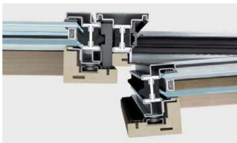
nodo centrale | sezione in vista 145 mm
